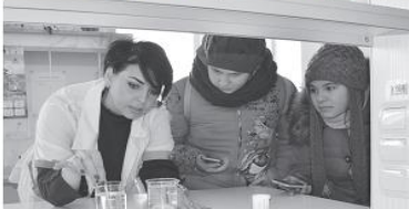
Фильтрация воды через песок и активированный уголь
